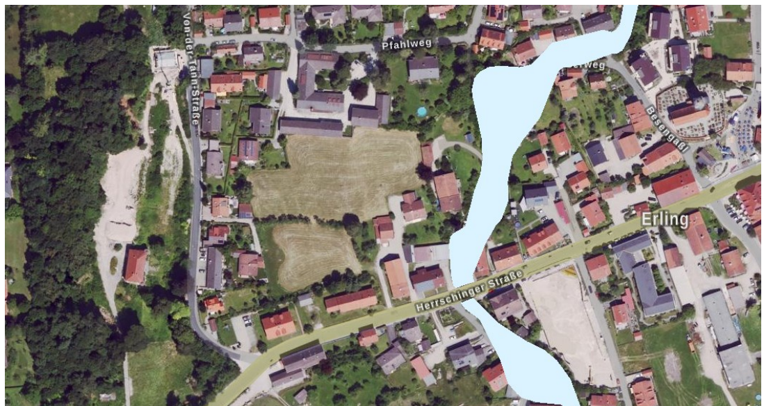
Abb. 6 Hochwasserrisikogebiet HQ Extrem, ohne Maßstab, Quelle: Bayernatlas, Stand 2023
